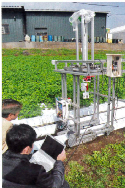
ロボットに設置したカメラで、うねに沿って自律走行ができるかテストする学生ら。
